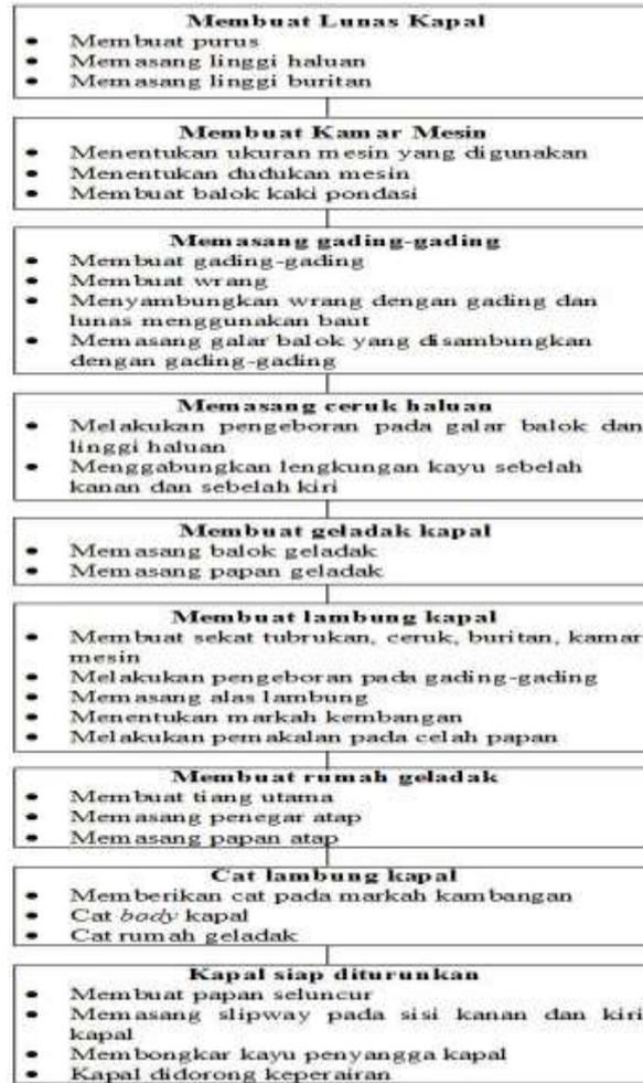
**Gambar 7.** Proses pembuatan kapal
